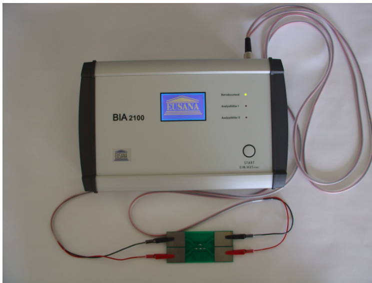
Abbildung 2 – BIA- Messgerät mit angeschlossener Prüfdummy-Platine zur Funktionskontrolle
